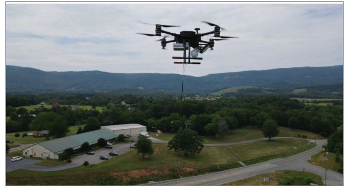
Şekil 3. İHA Tespit Amaçlı Kablo Bağlantılı İHA Sistemi [7]
