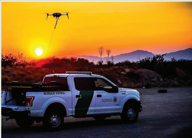
Şekil 2. Kablo Bağlantılı İHA Araç Takip Sistemi [6]
