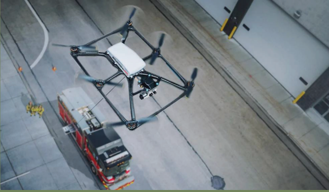
Şekil 4. İtfaiye Kullanımı Amaçlı Kablo Bağlantılı İHA Sistemi [8]
