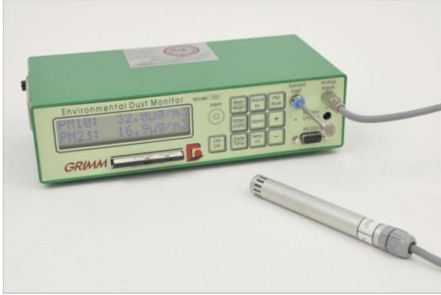
Şekil 2. Partikül madde ölçüm cihazı (Grimm EDM 107)
