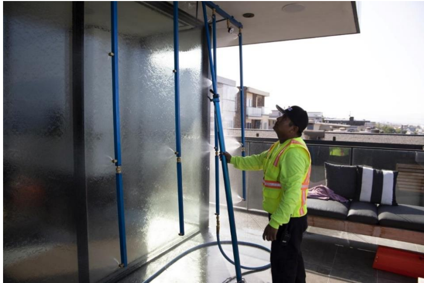
Saha su geçirimsizlik testi (ASTM E 1105)
