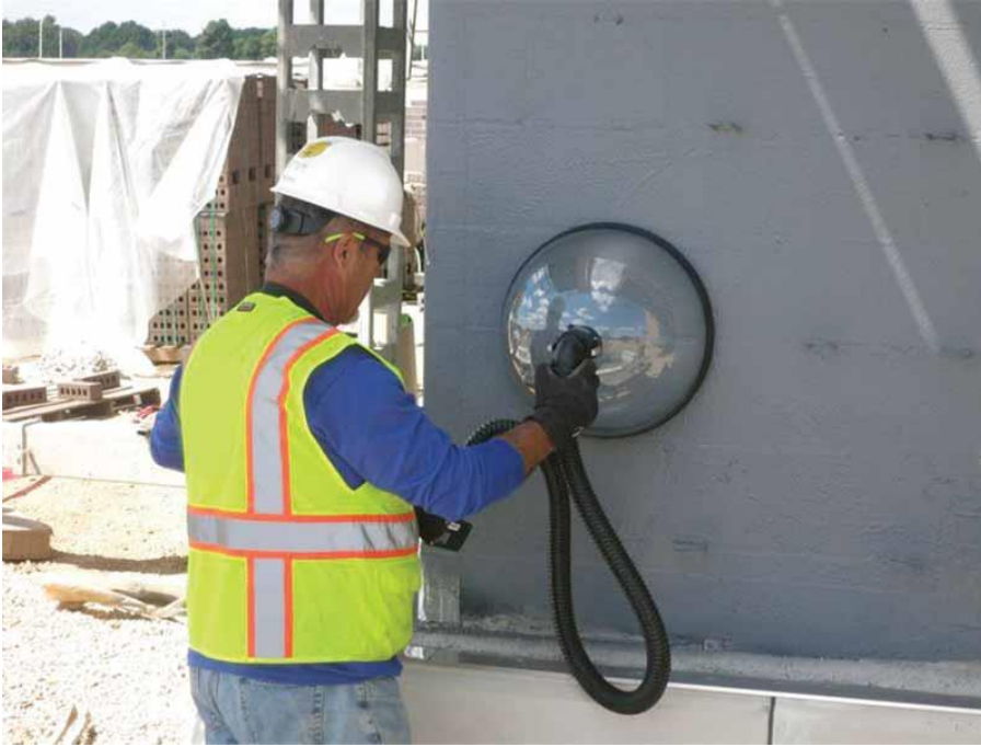
Isı ve hava kaçakları ile ısı köprülerinin tespit edilmesine dair kızılötesi kamera testi (ASTM E 1186)
