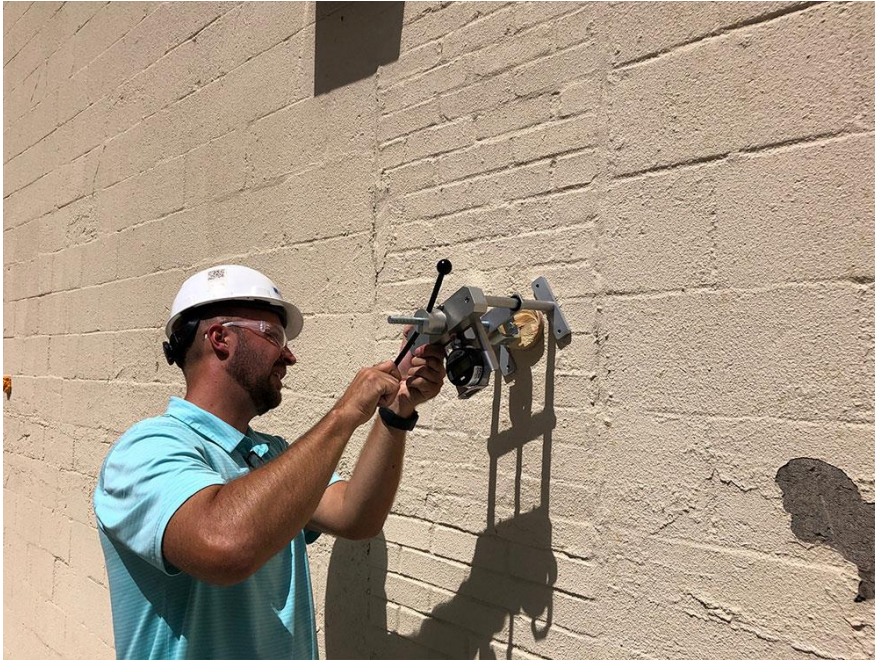
Yapışma/Aderans çekme testi (ASTM D 4541)
