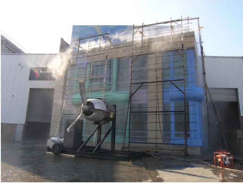
Figure 2 Dynamic Water test Maket cephe için basınçlı su testi
