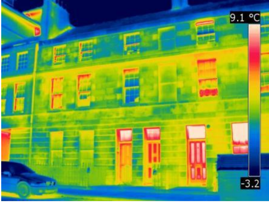
Isı ve hava kaçakları ile ısı köprülerinin tespit edilmesine dair kızılötesi kamera testi (ASTM E 1186)
