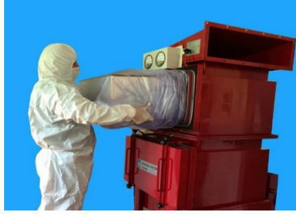
Resim 2. Canister filtre değişimi
