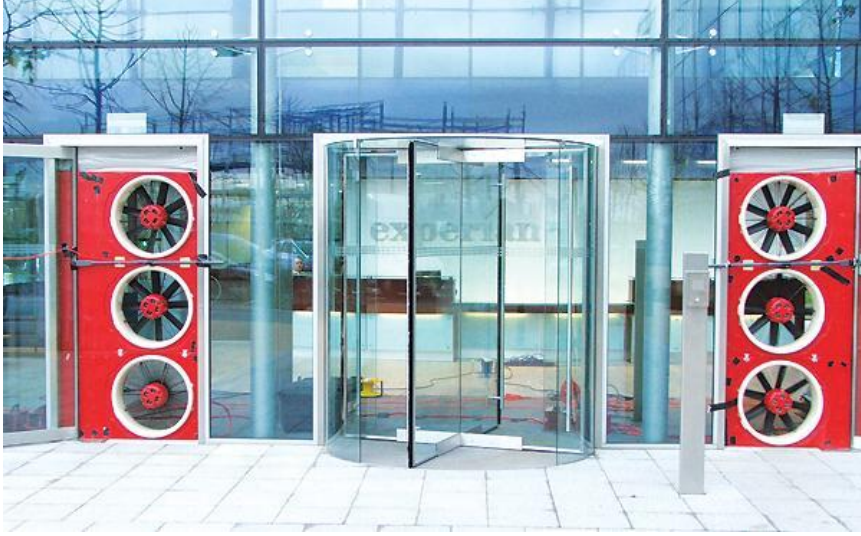
Tüm bina hava geçirimsizlik testi (ASTM E 779)
