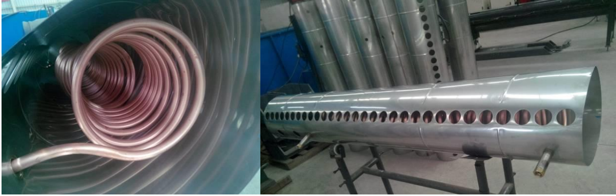
Şekil 3. Isı depolama ünitesinin bileşenleri ve iç görünümü
