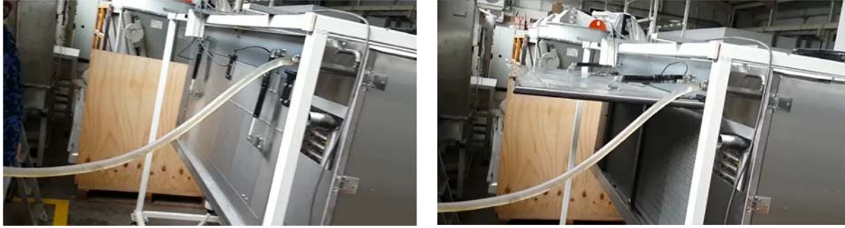
Şekil 1. Defrost Flap'ın Kapalı ve Açık Durumu
