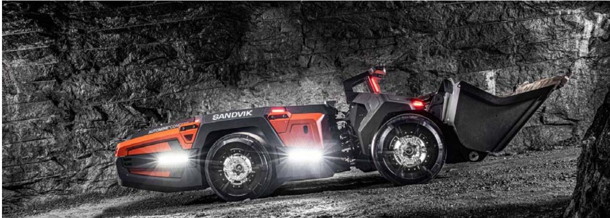
Şekil-31 Bataryalı (elektrikli) otonom yükleyici prototipi, 2020 [25]
