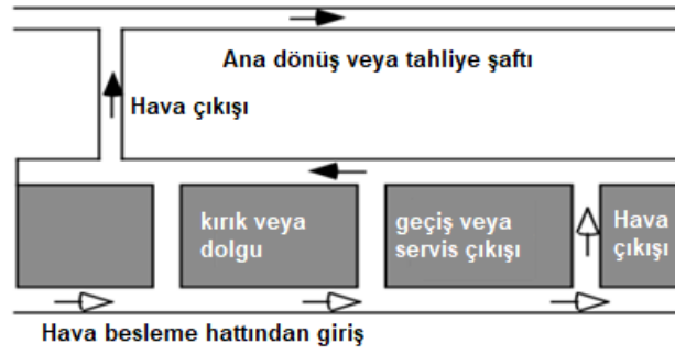
Şekil 18. Çekme veya kes-doldur durdurucuları için basit bir havalandırma sistemi örneği [5].
