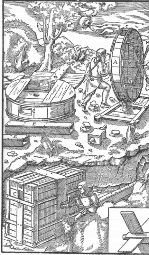
Şekil-1 Agricola tarafından tasarlanmış maden havalandırma sistemi. [20]
