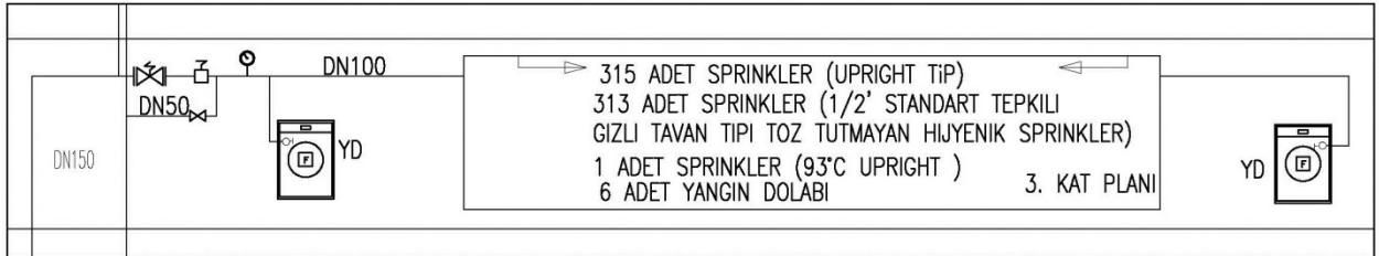
Şekil 13. Yangından Korunma Tesisatı Akış Şeması 3 kat.
