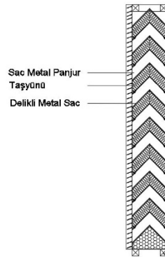
Şekil 11 Akustik Menfez Kesit Detayı
